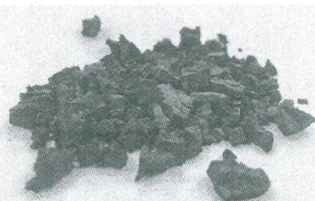
定置炉(下)で乾燥・焙焼処理したタンタルフラッジ
